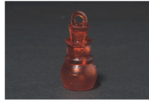
Pieza producida por fotopolimerización en tanque en una resina traslúcida
