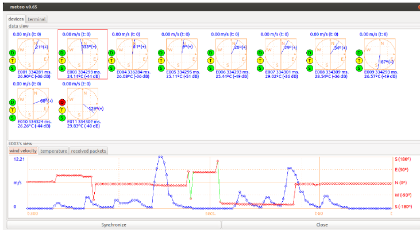
Figura 148: Software de monitorización y control en la estación base del sensor E003, durante una sesión de medición con diez sensores.
