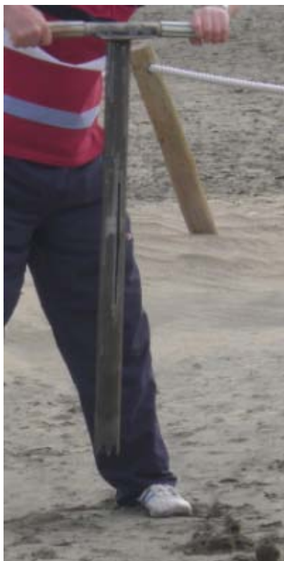
Figura 178: Realización de hoyos con barrena para la colocación de estacas.
