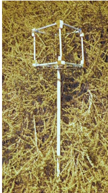
Figura 96: Dispositivo de extracción de muestras vegetales montado con jalón de madera en un individuo de Traganum moquinii .
