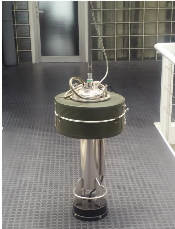
**Figura 1.5.** Radio-boya sonda, modelo SVA-C900ES (Ryokuseisha, Japón).
