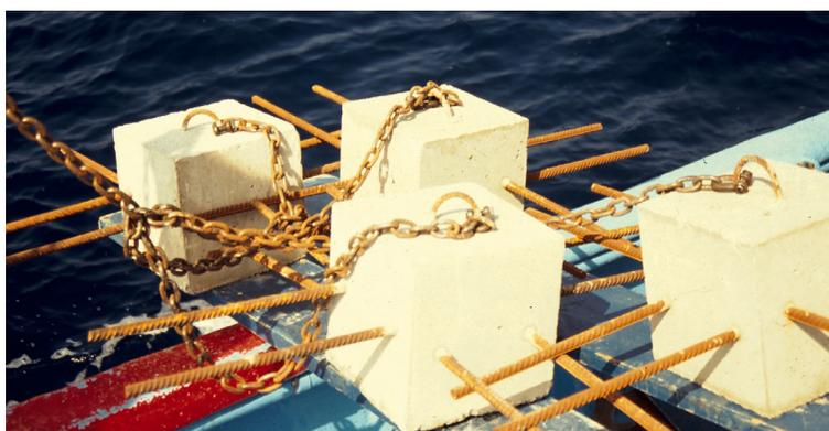
**Figura 1.4.** Bloques de hormigón utilizados para anclar los DAPs al fondo. Para reducir el arrastre y facilitar la fijación de los mismos al fondo, se añadieron varas de hierro.
