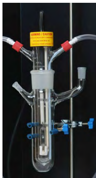
Figura 3.4. Reactor empleado para la fotodeposición de Pt sobre \text{TiO}_2 .
