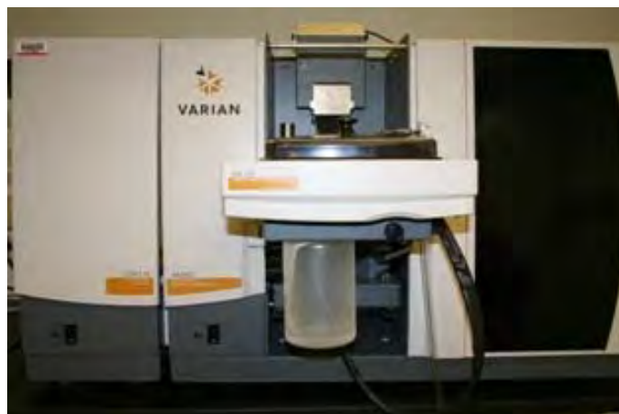
Figura 3.19. Espectrómetro de absorción atómica con cámara de grafito.
