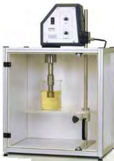
Figura 3.3. Equipo de sonicación para síntesis.
