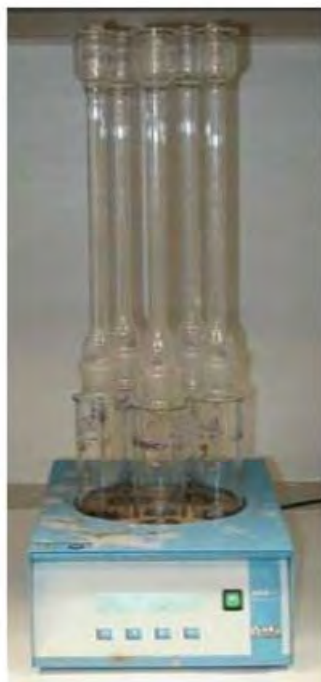
Figura 3.13. Digestor con bloque calefactor.
