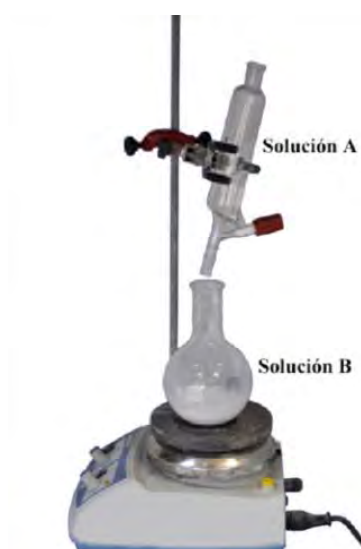
Figura 3.2. Montaje experimental para síntesis tipo sol-gel.
