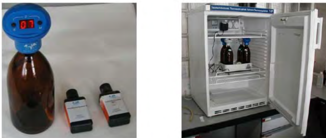
Figura 3.12. Botella con sensor de presión y disoluciones (izquierda) y cámara termostatzada con agitador y muestras (derecha).
