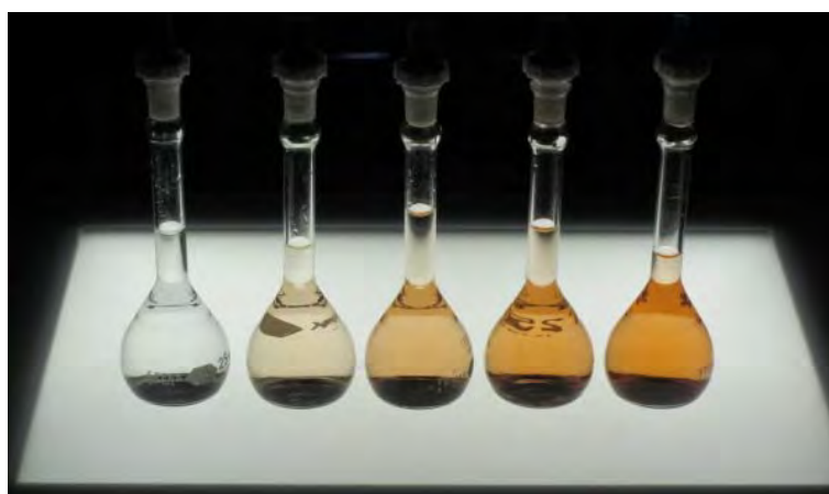
Figura 3.17. Determinación del hierro disuelto empleando el método de la o -fenantrolina.
