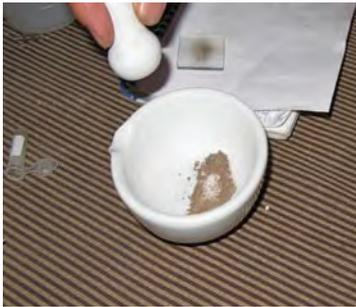
Figuras VII. 24. Molienda de la muestra para su posterior fijación. (Procedencia gráfica: Díaz, I.).
