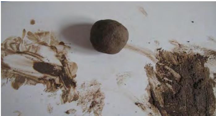
Se apreció una superficie brillante en la parte cortada, lo que indica una tierra con presencia de arcillas (*Figuras VI.9 y VI.10*).
