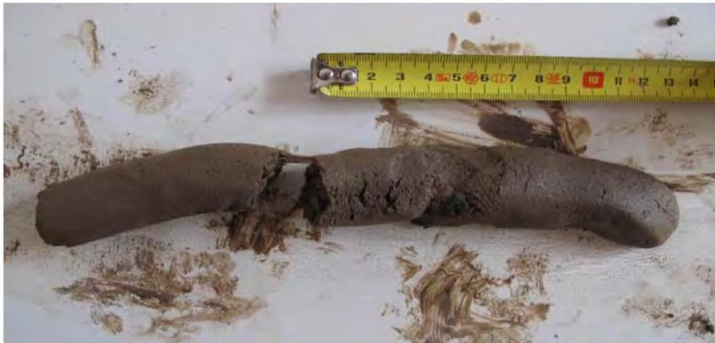
Figura VI.16. Resultado del test del rollo en el que la muestra analizada ha roto a los 120 mm: tierra óptima para ser empleada en tapial. (Procedencia gráfica: Díaz, I.).
