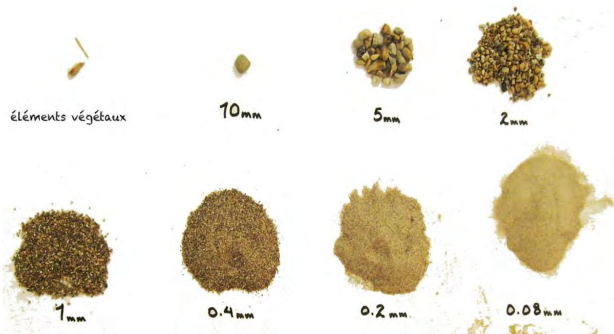
*Figura VI.6. Tierra cribada en diferentes tamices, lo que permite apreciar a simple vista la sección granulométrica y porcentajes de granos constituyentes de un suelo determinado (Procedencia gráfica: Hau, S.; Alvarez, N. y Leylavergne, E.).*
