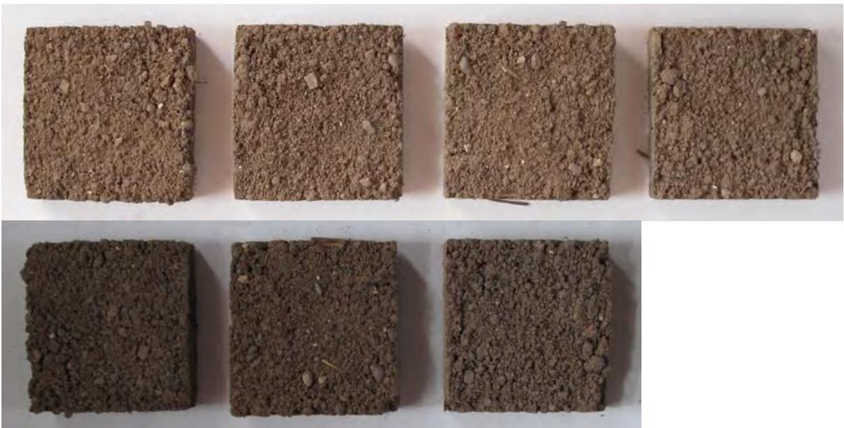
*Figura VI.25. Probetas realizadas con tierra de Guiniguada estabilizada homogéneamente con arena procedente de Tufia en proporciones idénticas de gránulos. Dimensiones: 4 x 14 x 14 centímetros. (Procedencia gráfica: Díaz, I).*
