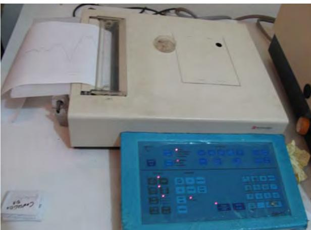
*Figura VII.22. Espectrómetro infrarrojo con el que se llevó a cabo la analítica. (Procedencia gráfica: Díaz, I.).*
