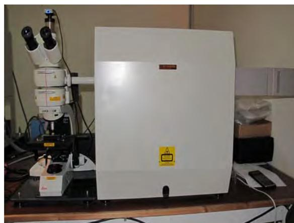
*Figuras VII.19 y VII.20. Haz de luz roja apuntando a la muestra e imagen general del Espectrómetro Ramán. (Procedencia gráfica: Díaz, I.).*
