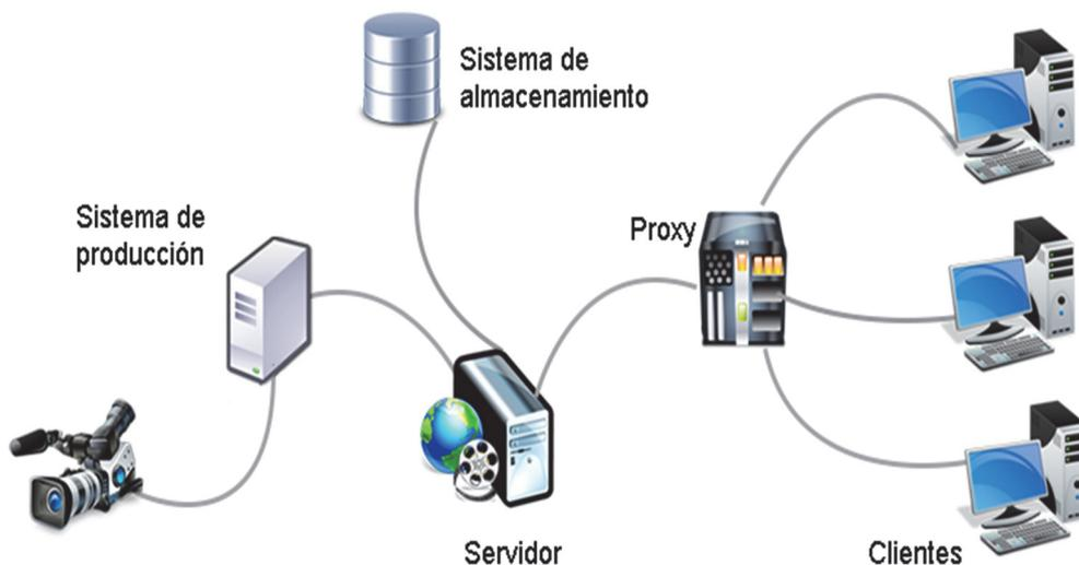
Figura 2.5 Arquitectura básica del servicio de video streaming
