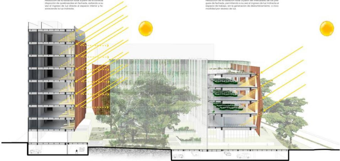
**Plano 197.** Diseño de fachada. Control pasivo de iluminación.
