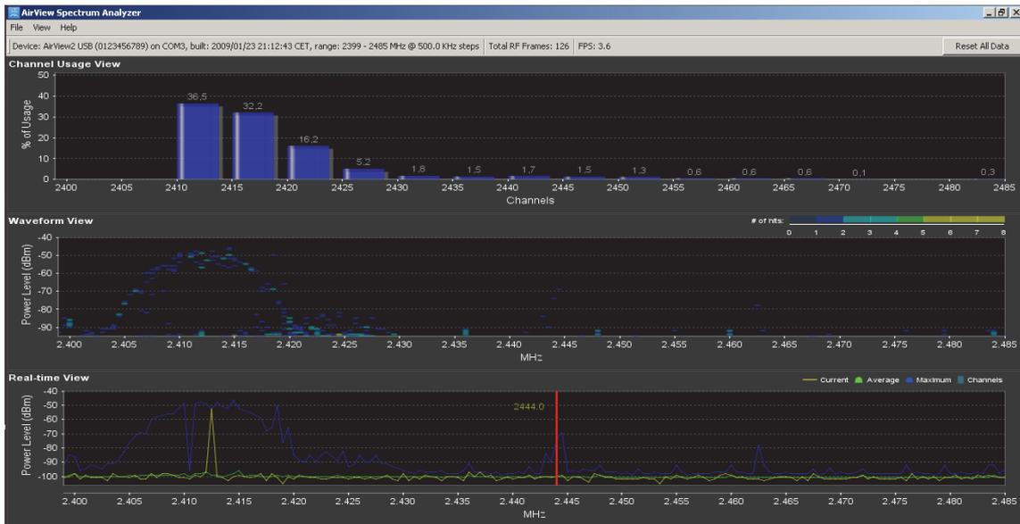
Figura 26. APTest24 en canal 1 en IEEE 802.11n (40Mhz)
