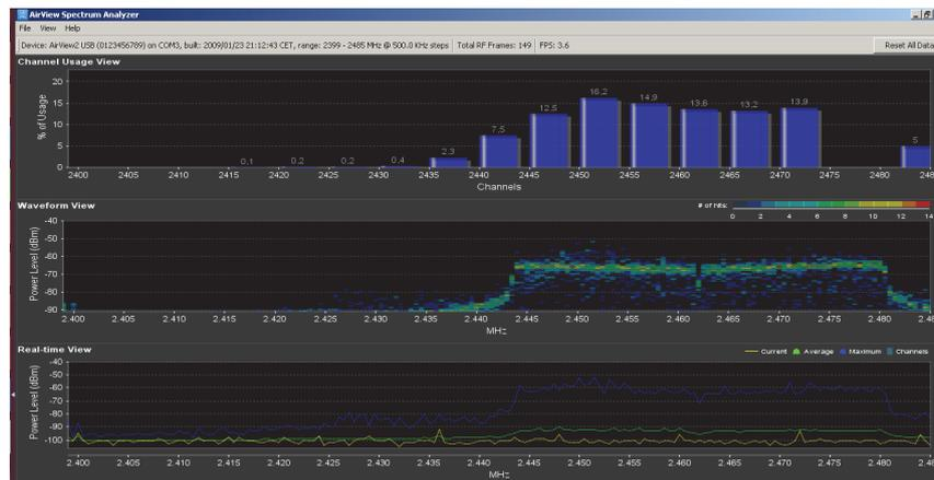
Figura 31. Resultado de hacer uso intensivo del APTest24 en el canal 9
