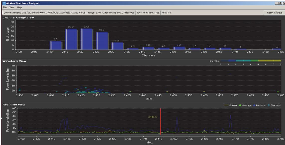
Figura 23. Estado inicial de la banda 2.4 GHz detectable por el analizador
