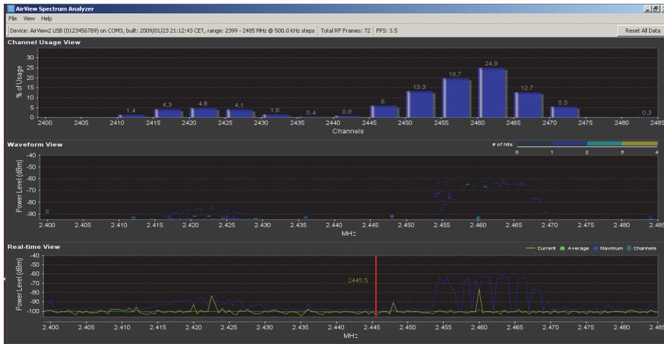
Figura 27. IEEE 802.11n en canal 11 modo legacy (compatibilidad bgn)
