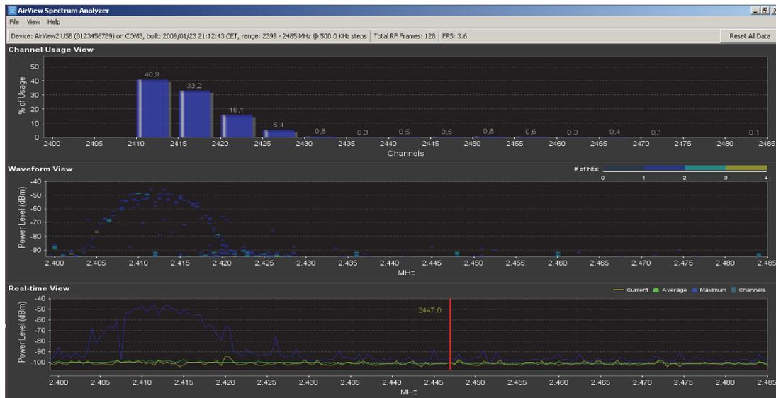
Figura 25. Espectro en 2.4 GHz con APtest24 en canal 1 y IEEE 802.11n (20MHz)
