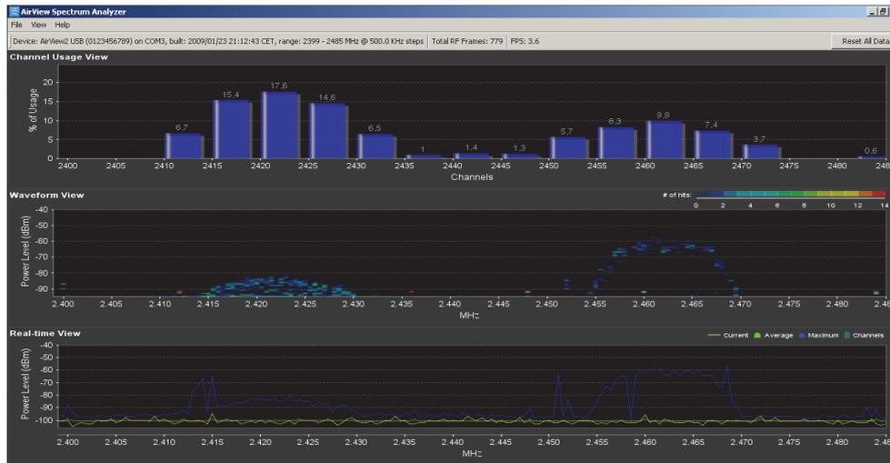
Figura 32. Espectro WiFi con zona baja muy utilizada y *APTtest24* en canal 11.
