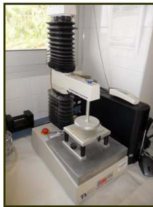
**Fig. 14:** Texturómetro
