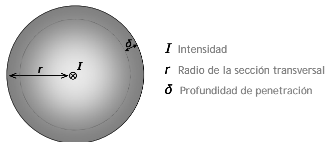
Figura 1.3 Efecto pelicular en un conductor de sección circular.
