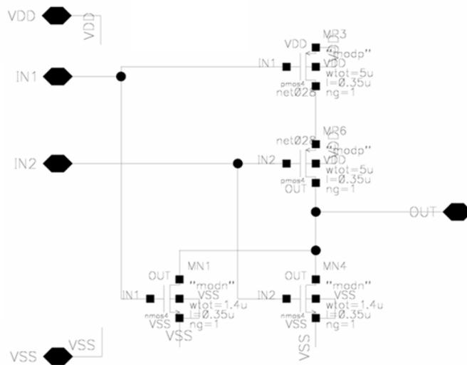
Figura 6.62. Esquema a nivel de transistores de la nor2.
