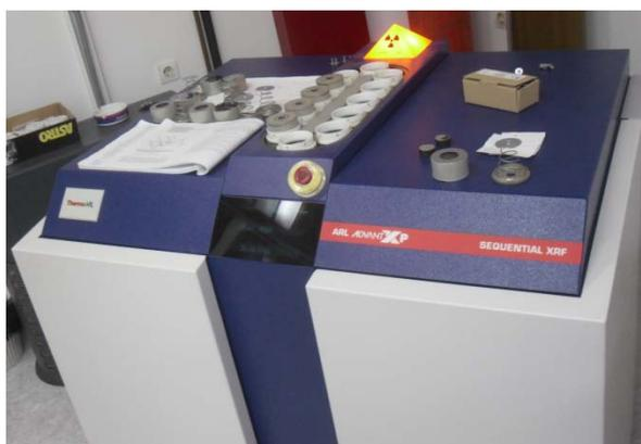
**Figura 20.** Equipo XRF modelo *ADVANT XP* [Elaboración propia].
