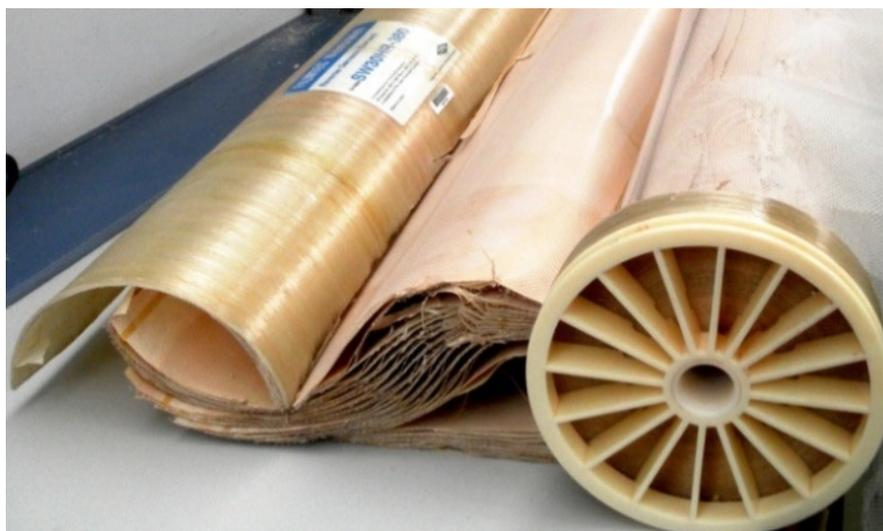
**Figura 17.** Disección del elemento de membrana virgen [Elaboración propia]
