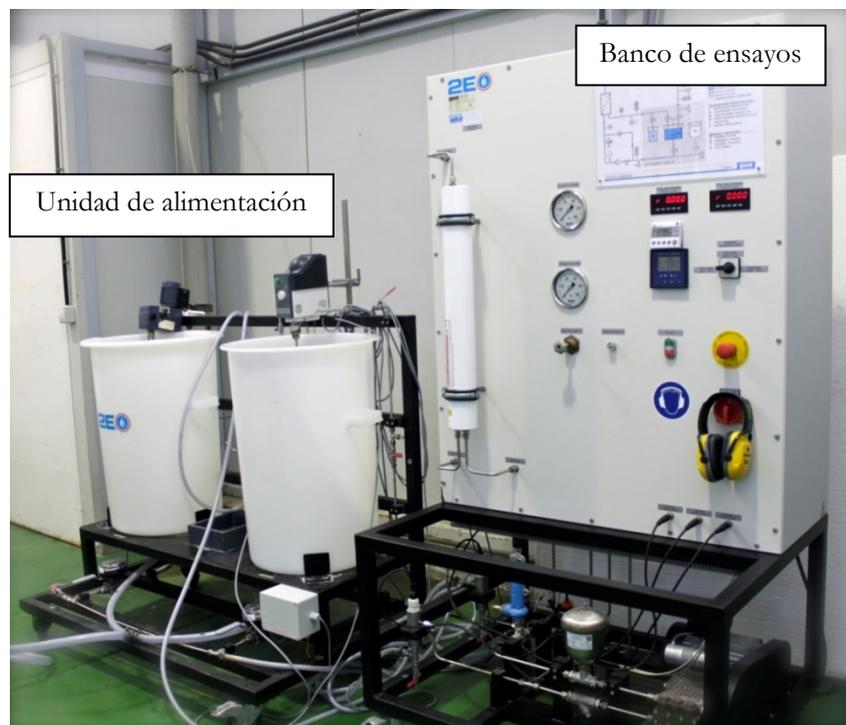
**Figura 21.** Vista general de la planta de ósmosis inversa [Elaboración propia].
