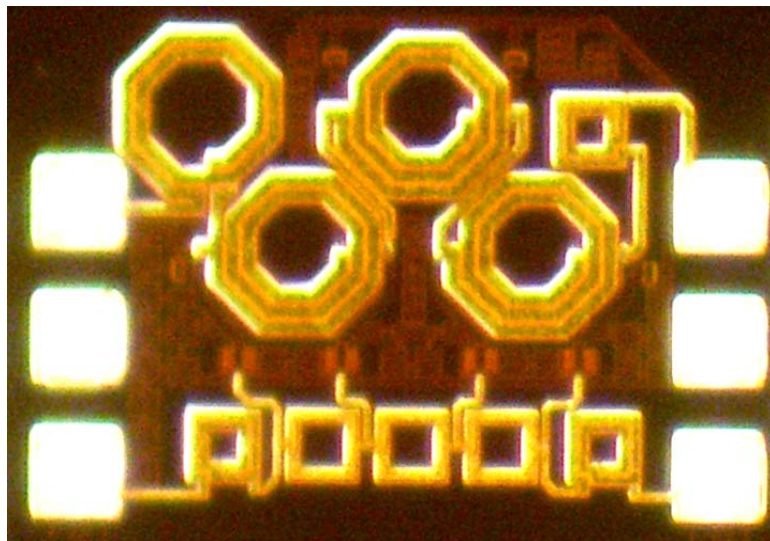
Figura 6.11 Fotografía del amplificador distribuido compacto 2.
