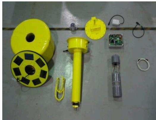
Fig.14(c) Despiece general de la boya. De izquierda a derecha: módulo de flotación, módulo de comunicaciones, módulo de electrónica, módulo de alimentación y módulo de sensórica
