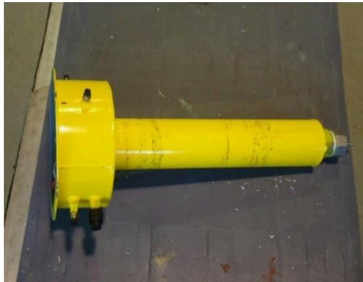
Fig.14(b) Imagen de la estructura central de la boya.
