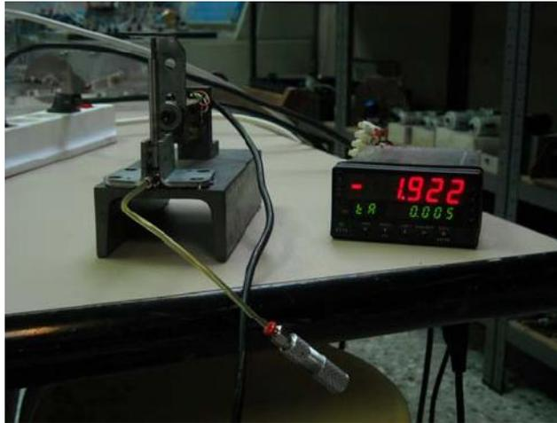
Por otro lado el movimiento del émbolo dentro del cilindro fue inapreciable tanto a los 30 minutos como a las 24 hs. Finalmente la resolución del control de la carga con el dispositivo es muy precisa. Así, tenemos que tras 24 hs de ensayo se podía controlar la carga aplicando una precisión de 0,1 N, girando el controlador.
