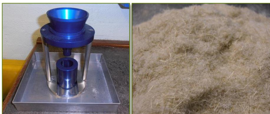
Figura 7. Fotografía del cono para la determinación de la fluidez del material (izquierda); material preparado con un 10 % de fibra de platanera (derecha)
