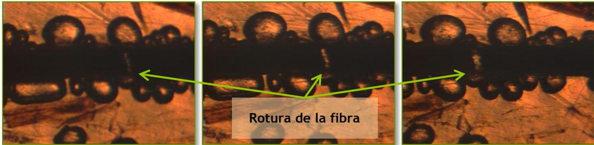
**Figura 27. Rotura de la fibra de platanera en la matriz de PE**
