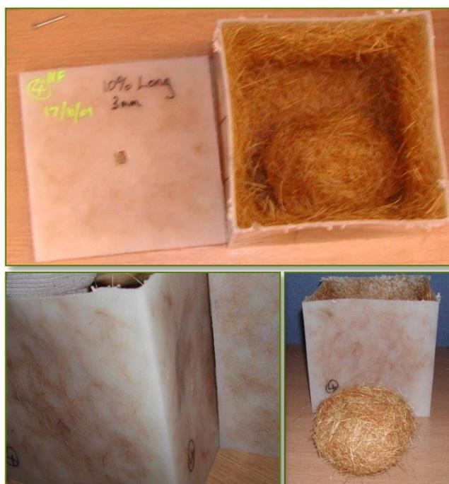
**Figura 5. Pieza obtenida con un 10 % de fibra de 25 mm de longitud, en un cubo de 3 mm de espesor (Sisal3)**
