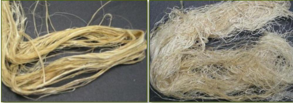
Figura 15. Fibra tratada con NaOH 0,1 N 1h (P) (izquierda) y con NaOH 1 N 1h (P) (derecha).
