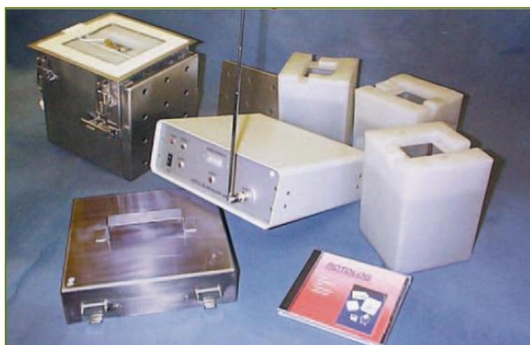
Figura 2. Componentes del sistema de transmisión de datos por radio, Rotolog
