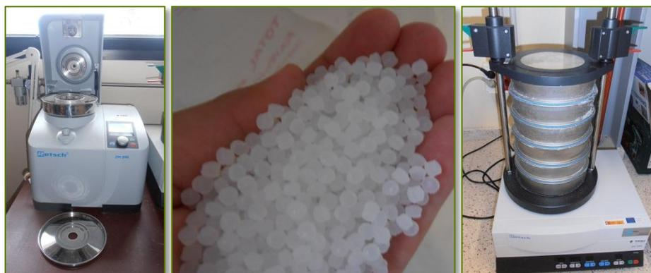
Figura 6. Fotografías del molino empleado, de la granza de PE de partida y de la tamizadora
