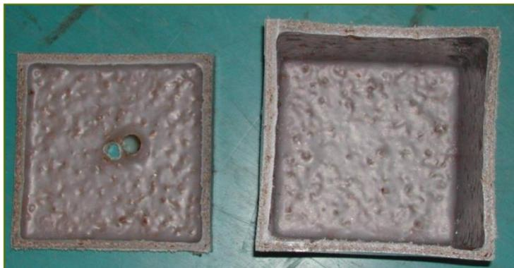
**Fotografía 5. Pieza obtenida con tres capas 0,65 kg PE + 0,06 kg fibra/0,435 kg PE + 0,02 kg fibra/0,435 kg PE, en un cubo de 8 mm de espesor (Sisal11)**
