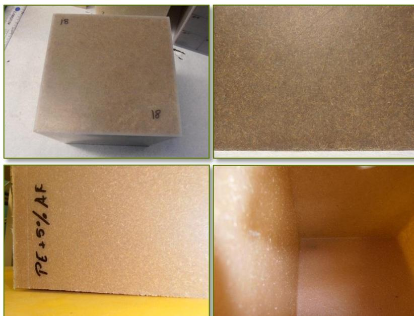
Figura 6. Arriba, pieza obtenida con 200 g PE/600 g PE + 5 % BF (formulación 18), a la izquierda y detalle de la pieza fabricada con PE + 5 % BF (formulación 22), a la derecha. Abajo, pieza obtenida con PE + 5 % AF (izquierda, formulación PE5) y aspecto de la parte interior de la pieza obtenida con 200 g PE/600 g PE + 5 % AF (derecha, formulación 3)
