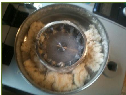
Fotografía 4. Aspecto de la fibra de abacá tras su paso por el micronizador (sin PE)
