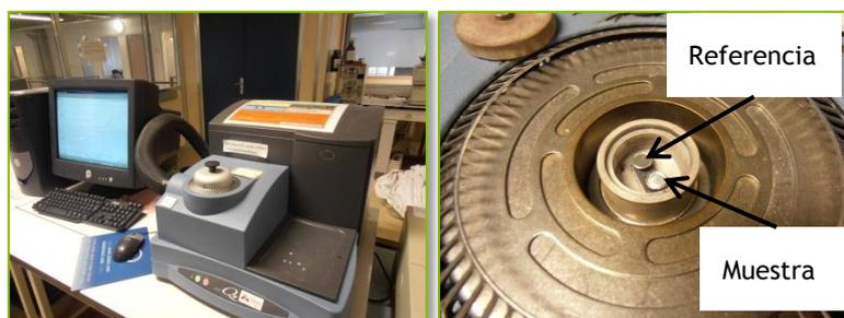
Figura 10. Equipo DSC Q10 empleado, y situación de los crisoles en su interior
