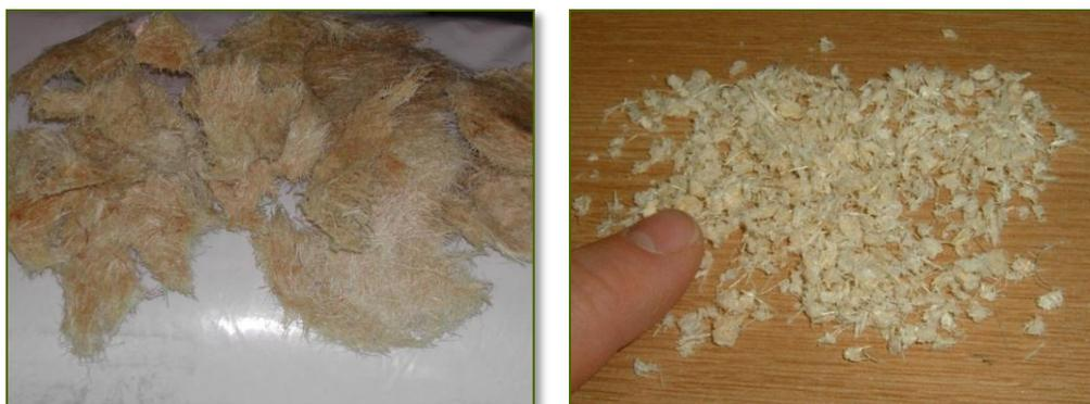
Figura 13. Fotografías de la mezcla de PE y fibra, antes y después de ser cortada, respectivamente
