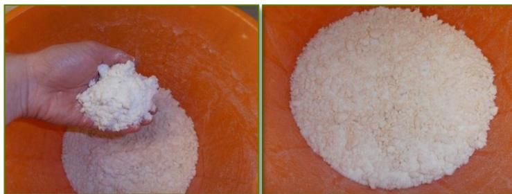
Figura 8. Material preparado con PE y un 5 % de fibra de abacá tratada
