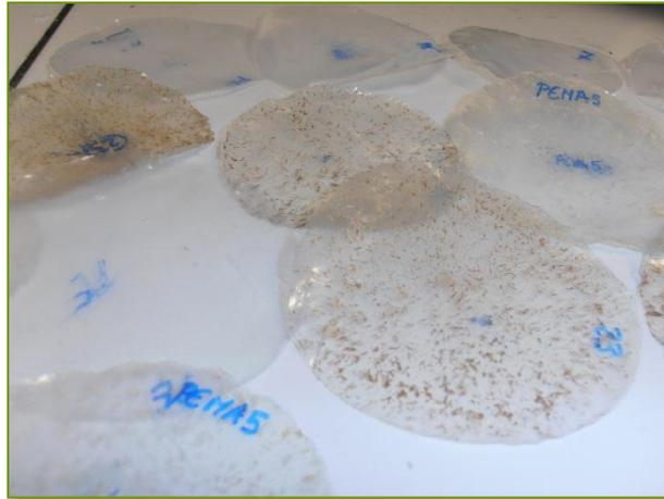
Fotografía 14. Láminas obtenidas tras el proceso de compresión
