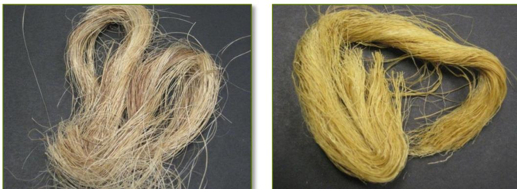
Figura 5. Fibra de abacá sin tratar (izquierda) y tratada con NaOH 4 N CN 4h + MA (derecha)
