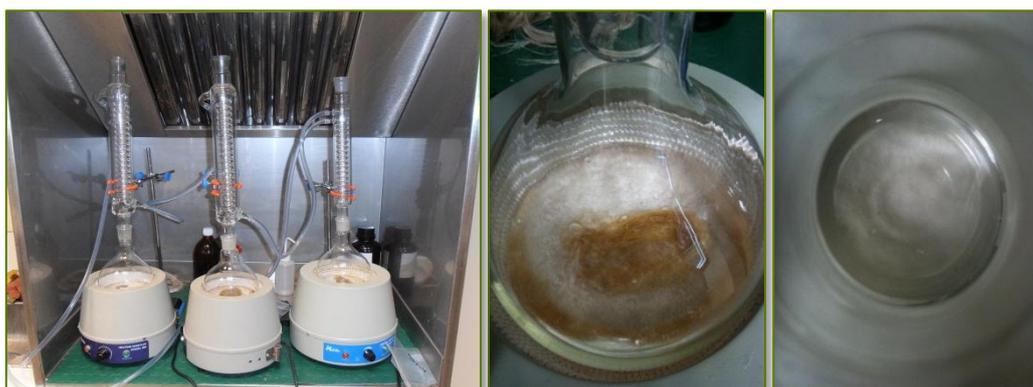
Figura 4. Montaje empleado en el tratamiento de la fibra con MA. Apariencia de la solución de tratamiento al final del mismo.
