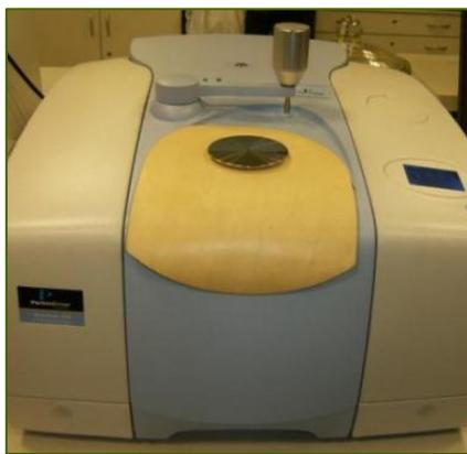
Fotografía 1. Equipo FTIR - ATR Perkin - Elmer Spectrum 100
