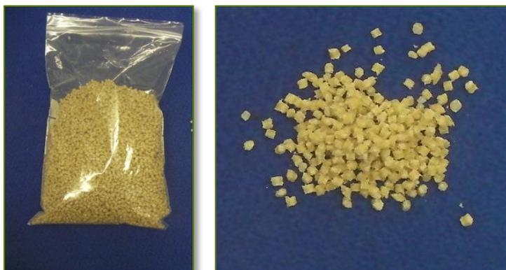
Figura 9. Fotografías mostrando el aspecto de los pellets de compound de fibra de platanera al 20%
