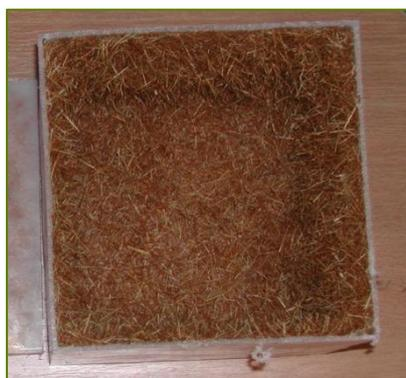
Fotografía 3. Aspecto interior de la pieza obtenida con un 10 % de fibra de 10 mm de longitud
