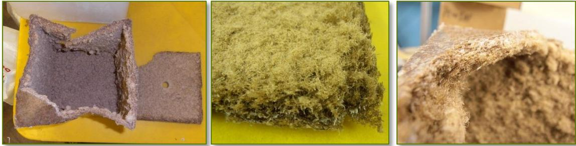
Figura 7. Diferentes fotografías de la pieza fabricada con un 20 % de fibra de abacá (formulación PEMA20)
