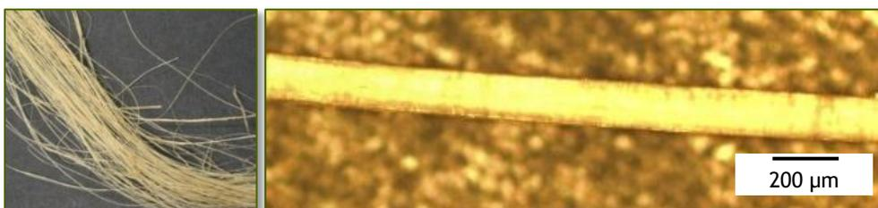
Figura 9. Fibra de platanera tratada con NaOH 0,1 N durante 1h
