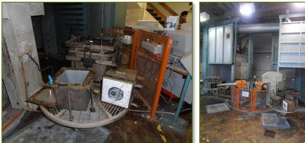
Figura 3. Máquina y molde de rotomoldeo empleados
