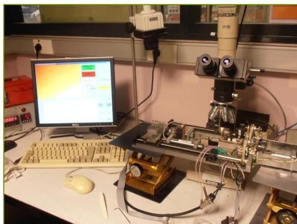
Fotografía 13. Equipo de microtracción con microscopio empleado
