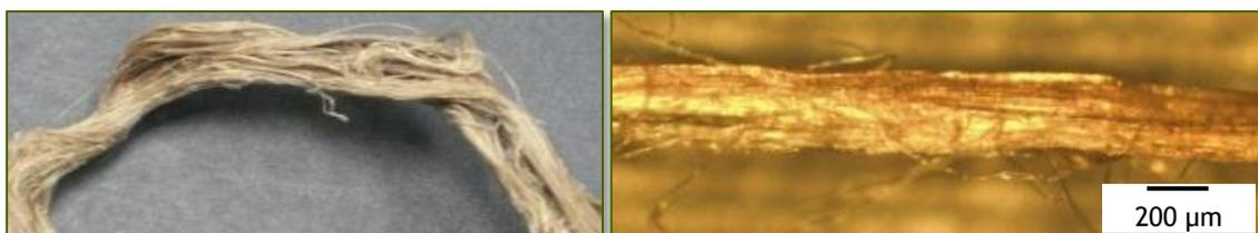
**Figura 10.** Fibra de platanera tratada con NaOH 1 N durante 1h. Se observa que la fibra se encuentra pegada, formando haces más gruesos (izquierda). La fibra presenta bordes rugosos y fibras finas que se separan del haz de fibras (derecha).
