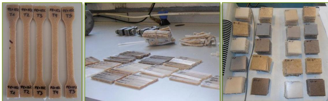
Figura 12. Fotografías de algunas probetas de tracción, flexión e impacto (de izquierda a derecha)
