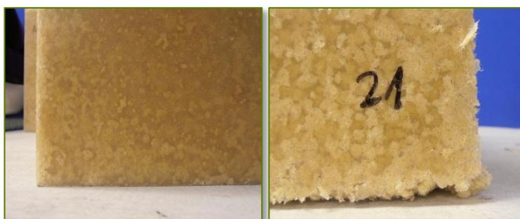
Figura 9. Detalles de las piezas obtenidas con 5 y 10 % de fibra de abacá tratada (formulaciones 20 y 21, respectivamente)
