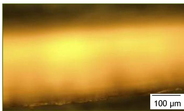
**Fotografía 7. Fibra tratada con NaOH 0,1 N durante una hora en condiciones ambientales, mostrando bordes ligeramente rugosos**
