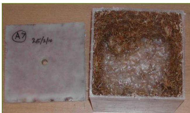
**Fotografía 4. Pieza obtenida con tres capas 0,43 kg PE/0,43 kg PE + 0,05 kg adhesivo + 0,02 kg fibra/0,55 kg PE, en un cubo de 6 mm de espesor (Sisal7)**
