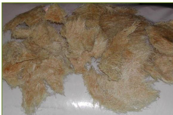
**Fotografía 3. Aspecto de la fibra tras aplicar en spray adhesivo**
