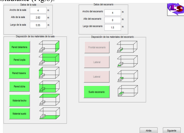
Fig. 9. Interfaz de usuario del entorno de simulación, sección de definición del recinto con todas sus características geométricas y condiciones acústicas.
