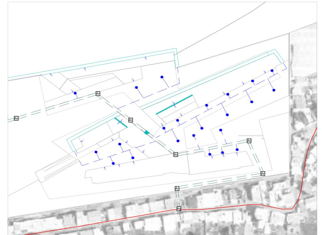
Debido a la inclinación de las cubiertas, en su mayor parte con un único plano de pendiente, se resuelve la recogida de pluviales, salvo en los casos de limahoyas, mediante recogida de aguas sobre el terreno en el espacio exterior. Estas aguas son llevadas a través de canalizaciones de pluviales a las arquetas de servicio por donde van todas las instalaciones básicas del hotel, para su posterior tratamiento y reutilización.
