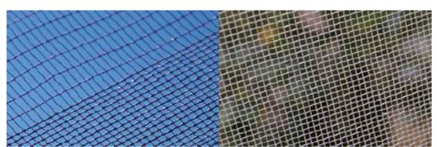
La malla monofilamento, la tela, otorga un 18% de sombra. Como se aprecia, esta malla es perforada para reducir en mayor medida la acción de arrastre del viento.
