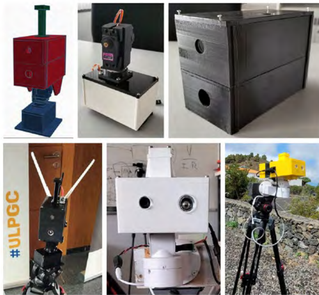
Figura 9. Prototipos desarrollados a partir de las pruebas en quemas controladas realizadas en puntos de Gran Canaria. De izquierda a derecha y de arriba abajo: diseño 3D; rotor azimuth/elevación de 180°/30° a partir de dos servomotores; visor vertical con cámaras visible y termográfica, modem 3G, alimentación, control y GPS; prototipo completo con IMU y antenas; tercera iteración del prototipo que reduce la altura e integra toda la electrónica con estación meteorológica para medida de temperatura, presión y humedad; prototipo completo con nuevo rotor 270°/60°; y última iteración instalada en torres fijas y usada en demos móviles que incluye sistema de apuntamiento y mejoras de aislamiento térmico para exterior.
