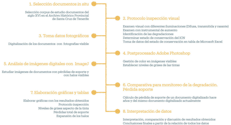
Figura 2. Metodología propuesta para aplicar a los documentos. Este flujo de trabajo aúna las prácticas actuales de inspección, con la incorporación del análisis de imágenes digitales con el software de código abierto ImageJ. Fuente: Autoras.
