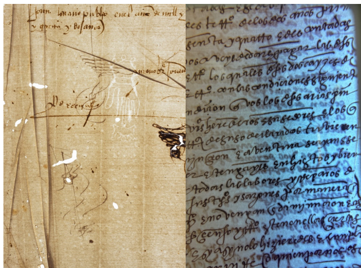
Figura 3. Inspección de los documentos. a) Uso de la luz transmitida para documentar las grietas y pérdidas de soporte por la corrosión de las tintas; b) Inspección in situ con lámpara ultravioleta. Fuente: Autoras.
