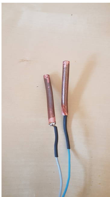
Figura 4.46: Ejemplar con tubos de cobre utilizados como elementos conductores térmicos en los cables.
