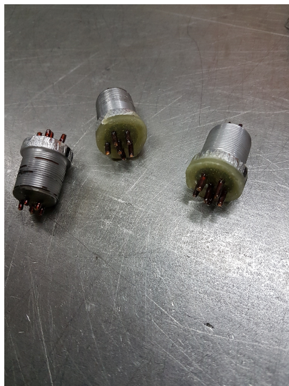
Figura 4.18: Terminales de cobre encapsulados individualmente en epoxi.
