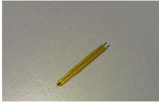
Figura 4.3: Termistor de película delgada tras la reducción de sección del encapsulado.
