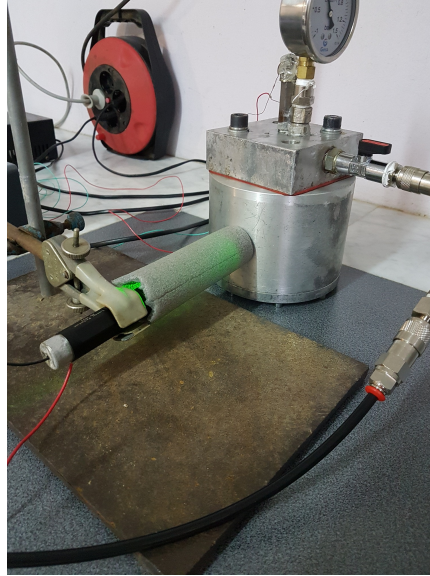
Figura 4.27: Encapsulado del puntero láser para mejora de estabilidad térmica.
