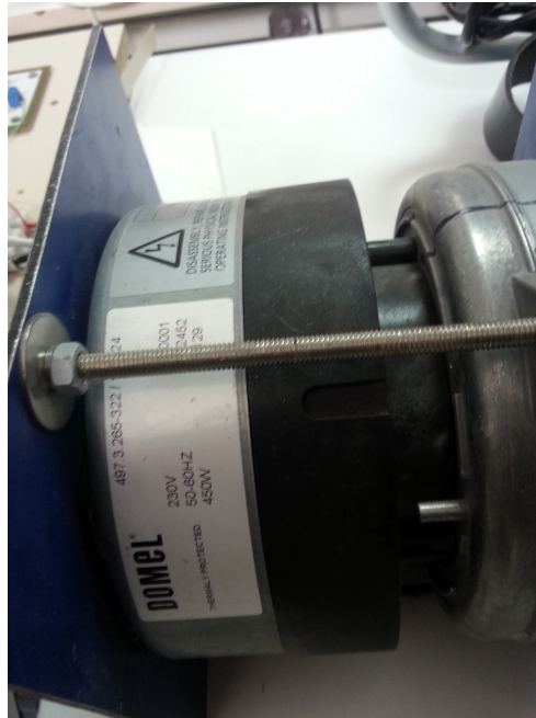
Figura 4.11: Detalle de la soplante centrífuga utilizada.
