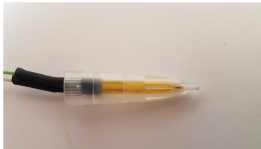
Figura 4.9: Prototipo intermedio con termistor de película delgada para reducir interferencias térmicas.
