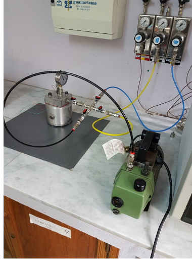
Figura 4.38: Vista de los equipos del ensayo: cámara adiabática, bomba de vacío y conexiones a la distribución de los gases técnicos.
