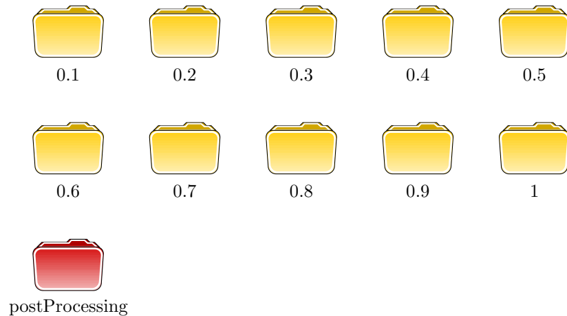
Figura 3.8: Vista de las nuevas carpetas creadas una vez reconstruida la descomposición donde se ha realizado una simulación de un segundo con un paso temporal de 0.1 segundos. Las carpetas amarillas contienen los datos de los campos escalares y vectoriales para cada paso de tiempo, mientras que la carpeta posProcessing almacena en un fichero de texto plano las fuerzas medidas sobre el cilindro. Esta última carpeta se crea durante el proceso de simulación.
