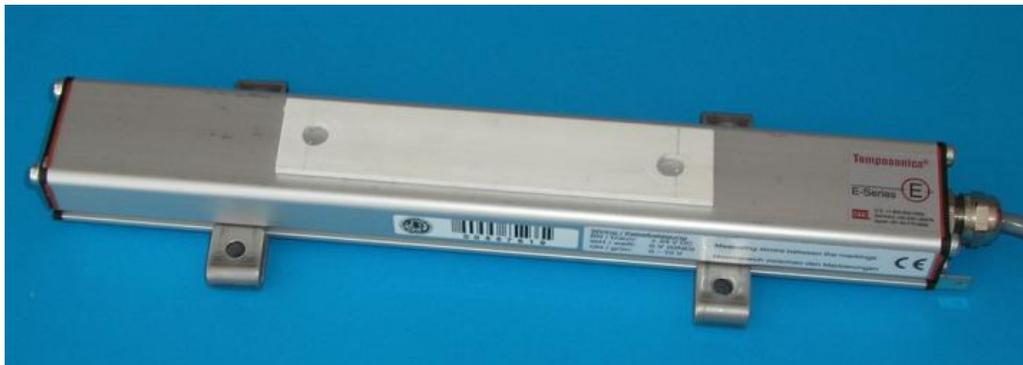
El fabricante del sensor recomienda que la distancia entre el imán y el cuerpo del sensor se mantenga entre 1 y 5 mm. Con la placa intermedia de fibra de vidrio se garantiza la separación mínima.
