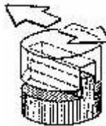
Si se eliminan los dos extremos de la espiga de la pieza inferior para que no quede más que su parte central, cuyos diámetros no deben superar la anchura de la ranura, habremos reemplazado la espiga por un pivote cilíndrico, susceptible de ser introducido en la ranura de la pieza superior.
