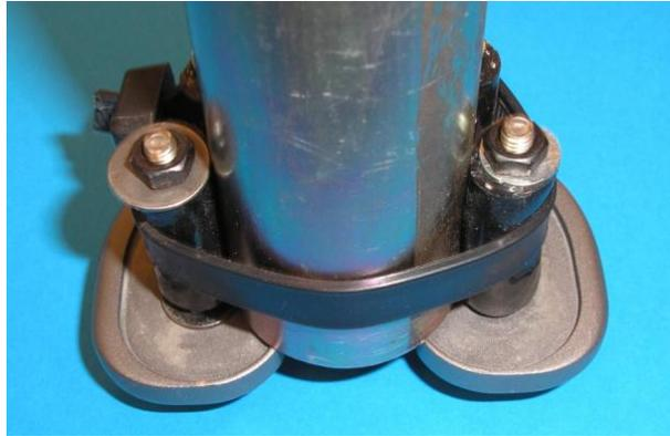
Este montaje se coloca sobre la meseta tibial del espécimen de tibia cuya preparación se ha detallado anteriormente.
