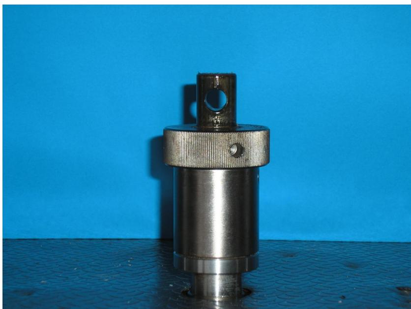
Además de la morfología y dimensiones de dicho dispositivo, en el diseño de la unión debe considerarse que esta debe impedir el movimiento en el plano sagital (flexión) y permitir el giro libre en el plano frontal, lo cual resulta imprescindible para la aplicación de cargas excéntricas. De este modo, se logra una rótula con posible libertad de movimiento en un sólo plano, que posteriormente se puede anular una vez adaptada a la angulación o valgismo de la muestra.
