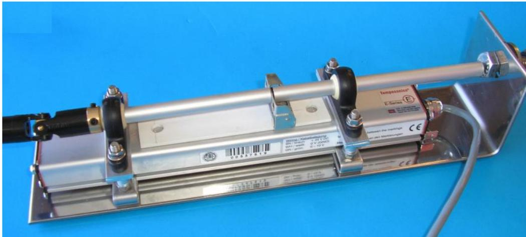
Una vez completado el montaje del sistema de medida, se atornilla al conjunto superior del sistema superior. Para ello se utilizan tornillos, tuercas y arandelas planas iguales a las empleadas para atornillar la placa a la mordaza. Se emplean por tanto tornillos de A4-80 (AISI 316) DIN 933 de métrica 10 y 40 mm de longitud. Las tuercas son DIN 934 de A2-70 (AISI 304) y 8 mm de espesor y las arandelas planas anchas DIN 9021 de AISI 304 M10.
