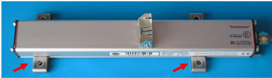
A través de estas piezas, cada sensor se atornilla a una placa base de AISI 304, de 3 mm de espesor, en la que se han mecanizado 4 taladros pasantes de 5 mm de diámetro. Se emplearán tornillos DIN 933 de AISI 316 de métrica 5 de 50 mm de longitud y cabeza hexagonal y tuercas DIN 934 de AISI 316. El diseño de dicha placa se muestra en la siguiente figura.
