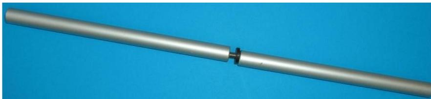
Las varillas de aluminio deslizan en el interior de los cojinetes y llevan en su extremo un acoplamiento.
