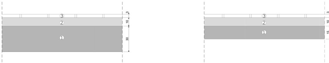
El análisis de esta solución nos permite optimizar el canto del forjado para evitar un gasto de material innecesario. Se estudiará la importancia del espesor a efectos de reducir la temperatura en el interior de los edificios.
