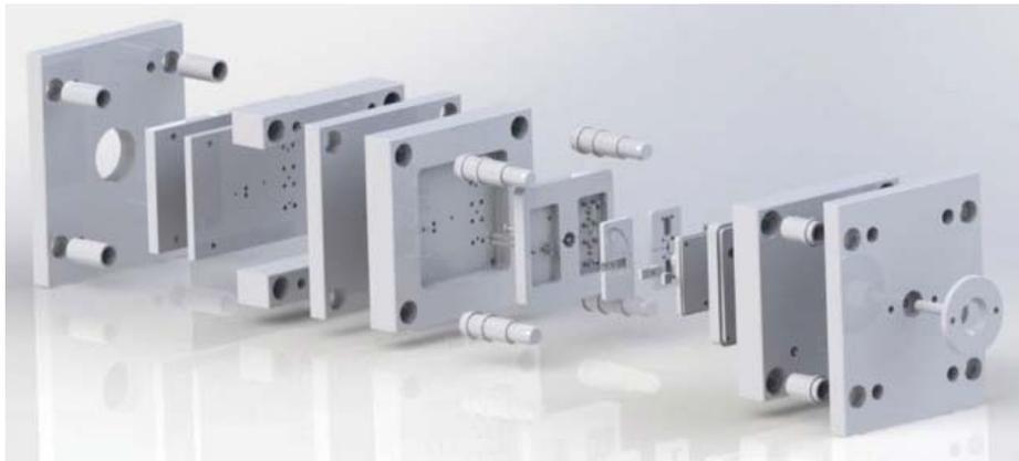
**Fig. 2.** Vista explosionada del molde desarrollado.
