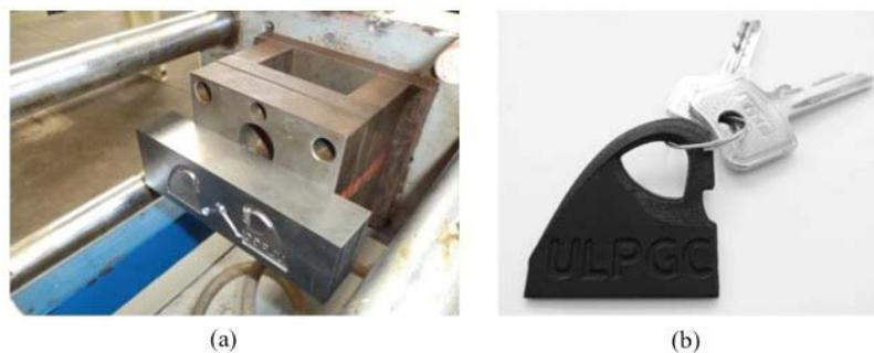
**Fig. 4.** (a) Molde prototipo y (b) pieza final inyectada.
