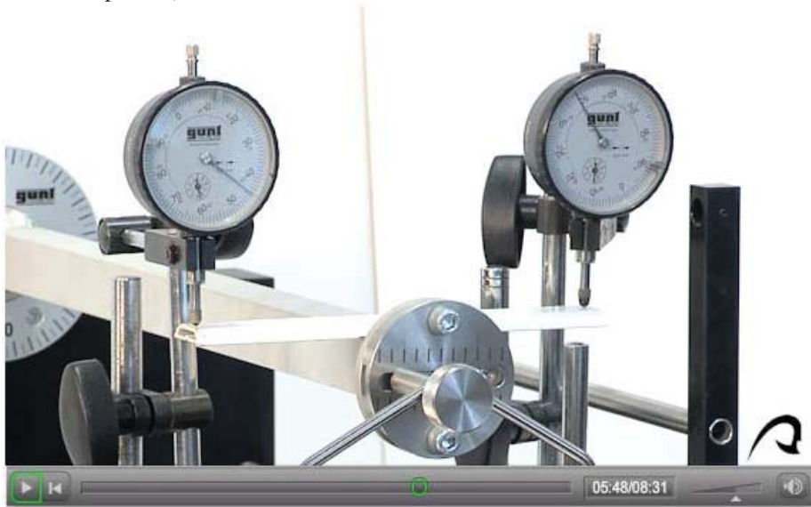
Fig.6. Detalle de medición sobre el GUNT-FL-160 modificado.
