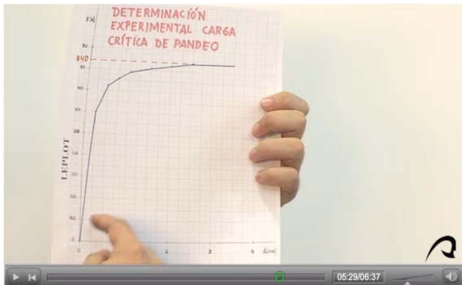
Fig.11. Gráfica que permite la determinación de la carga crítica de pandeo a partir de las medidas obtenidas durante la práctica.
