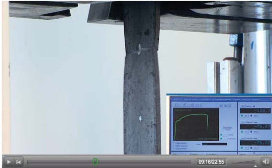
Fig.3. Momento de la rotura de la probeta.
