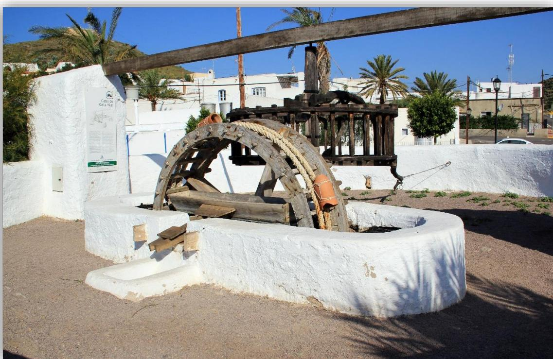
Fotografía 9.3: vista lateral de la noria de sangre restaurada, que se empleaba para extraer el agua desde el Pozo de los Frailes. Captura del 12 de abril de 2011.
