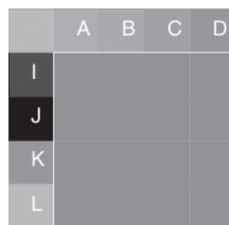
Figura 2.7: Predicción DC aplicada a bloque de 4×4. Fuente [3].
