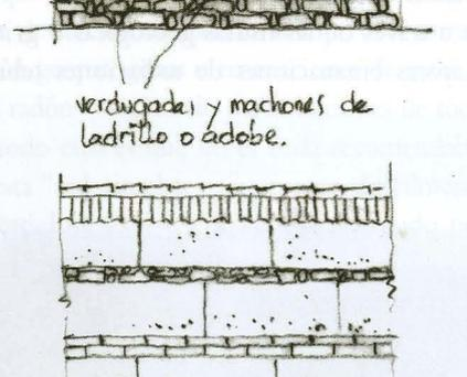
Arriba: Contraste entre hormigón visto y las construcciones experimentales de tierra cruda en el Campus de Tafira, Las Palmas de G. Canaria. Sobre estas líneas y a la derecha: Esquemas de paredes ejecutadas con tierra apisonada o tapial.
