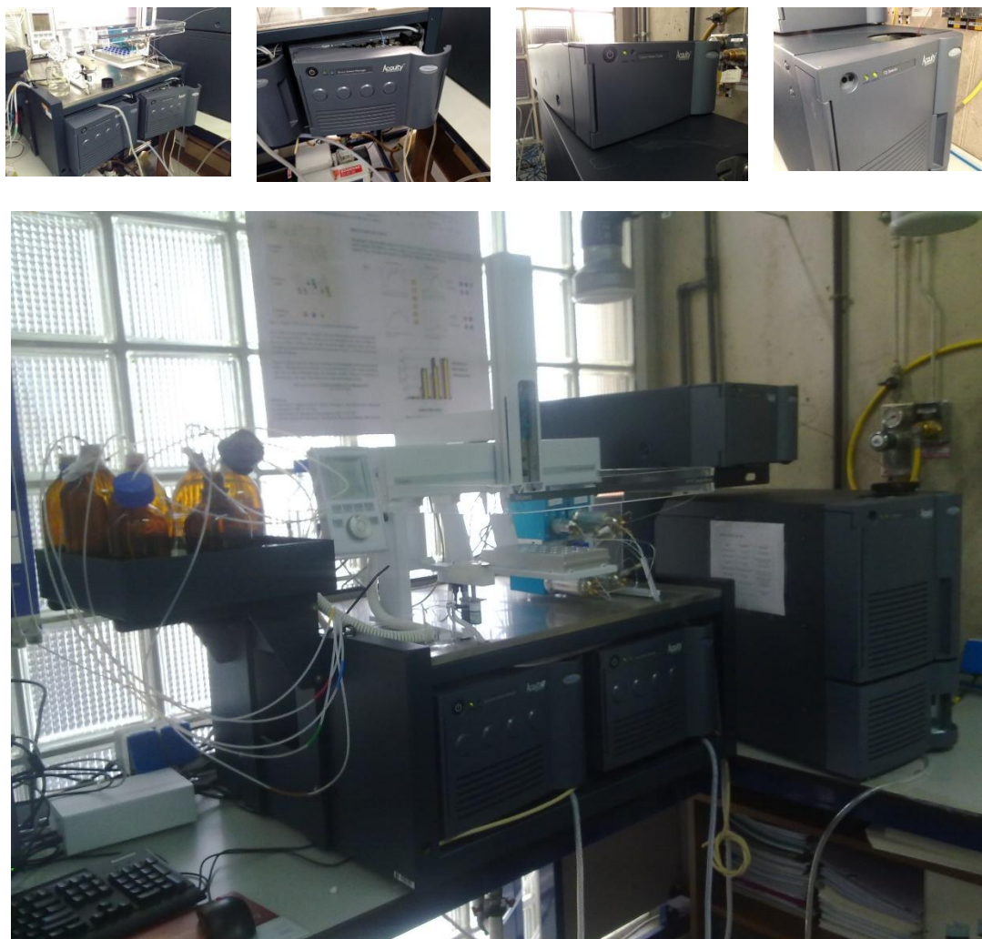
Ilustración 3. Sistema de cromatografía líquida de ultra alta resolución acoplada a espectrometría de masas en tándem (UHPLC-MS/MS) de la marca Waters. Fuente: Elaboración propia.
