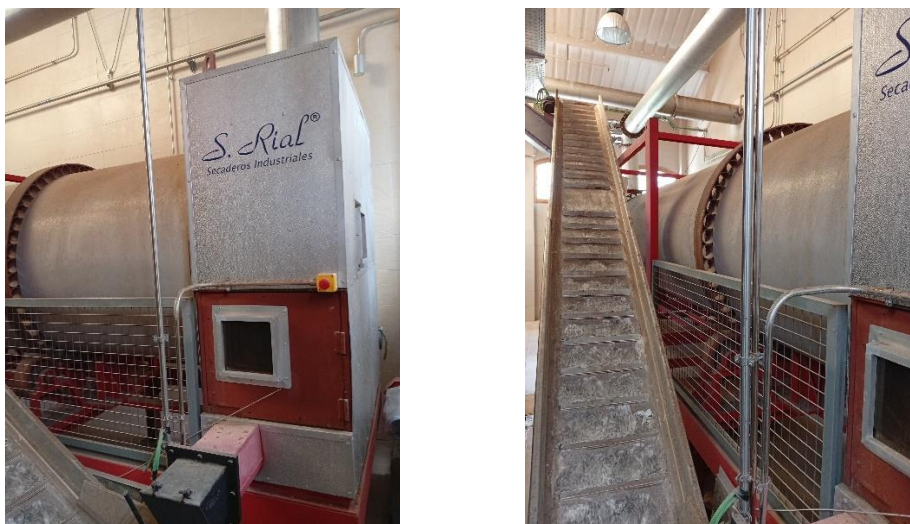
Fotografía 8. Trómel de secado
