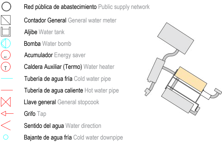
PLANTA DE LA DISPOSICIÓN REAL DE LAS TUBERÍAS Y CODOS E 1:20
