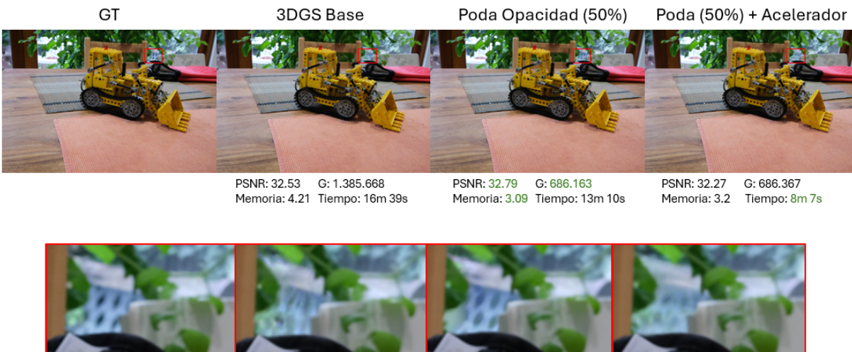
Ilustración 7.3: Comparativa visual de la escena Kitchen. Las técnicas con poda simplifican algunas estructuras de alta frecuencia como el patrón de la valla.
