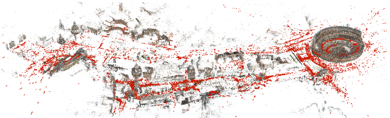
Ilustración 3.6: Nube de puntos generada con COLMAP a partir de un conjunto de imágenes. Imagen adaptada de [1].
