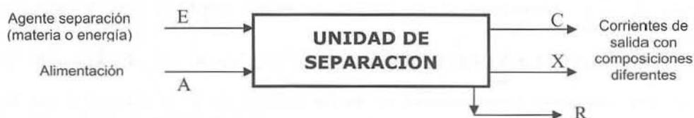
Figura 1. Esquema general de un proceso de separación
