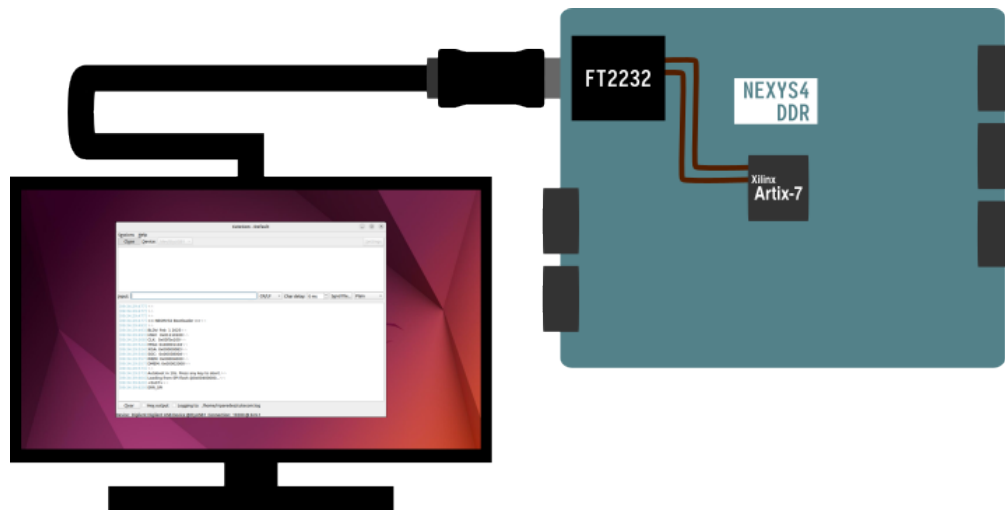
Figura 5.10: Esquema de conexión del NEORV32 con la computadora.
