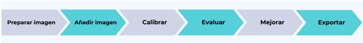
Figura 78. Flujo de trabajo para la calibración del sistema estéreo
