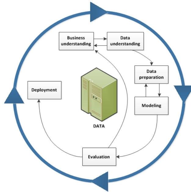
Ilustración 4.1: Diagrama del proceso CRISP-DM ( Cross-Industry Standard Process for Data Mining ), que describe las fases estándar en proyectos de minería de datos. Fuente: IBM SPSS Modeler Documentation .
