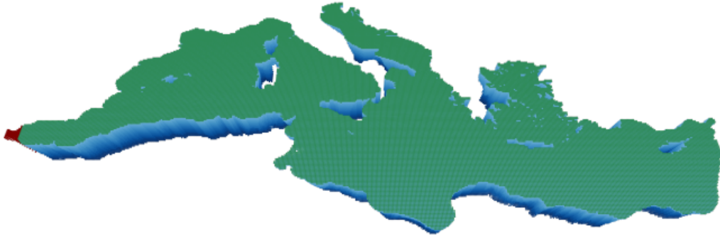
Figura 5.7: Imagen representativa del dominio del modelo SeaCast. El color marrón indica el forzante de contorno, el verde la capa superficial del mar y el azul representa las zonas de mayor profundidad. Fuente: [Holmberg et al., 2024]
