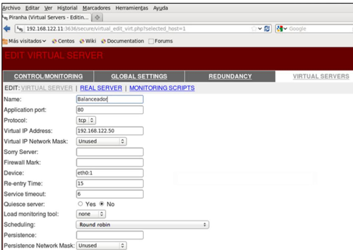
Por último se configurará cada uno de los servidores reales encargados de procesar las solicitudes de los clientes. Únicamente es necesario indicar la IP del servidor y el puerto del servicio que se está balanceando. En este caso:
