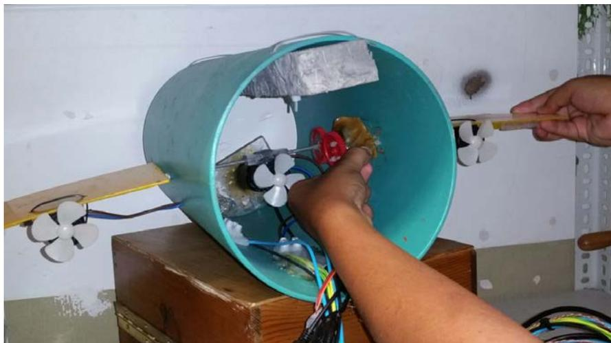
Conjunto de propulsión y direccionamiento horizontal constituido por los tres motores convencionales y servo que permite el direccionamiento vertical controlado por potenciómetro acoplado a Arduino.
