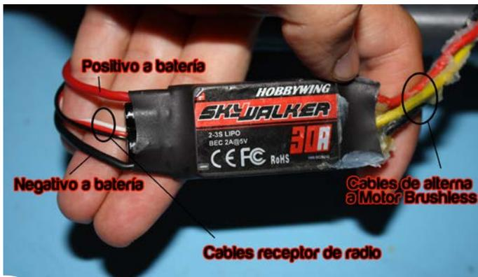
Ilustración 7: Variador de potencia del motor Brushless.
