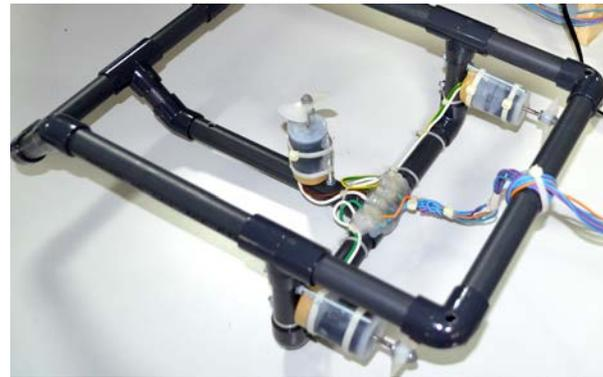
El chasis del ROV que se muestra en el **Manual de construcción de un ROV** está compuesto por tubos y conectores de PVC de 20 mm de diámetro. Por simplicidad se recomienda usar el modelo de presión sin rosca.
