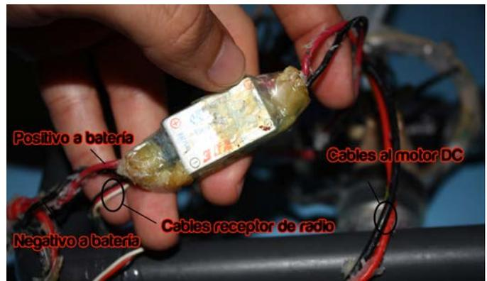
Ilustración 8: Variador de potencia del motor DC.
