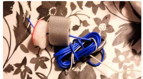
Ilustración 11: Detalle antena con corcho para flotación.
