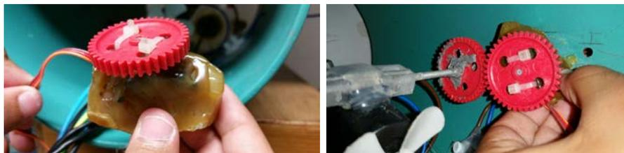
Motor servo acoplado al eje mediante engranajes, pueden observarse los tres cables; control, positivo y negativo.
