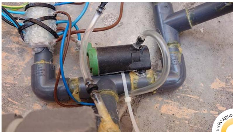
Inyectándole aire al robot hacíamos que la estructura se llenara de aire y así hacíamos que el robot subiera a la superficie.
