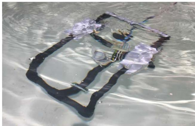
Para lastrar la parte delantera se han usado tuercas de alto calibre (M16), ya que debido a su forma se pueden anclar fácilmente a la estructura, pero cualquier material de alta densidad también es válido.
