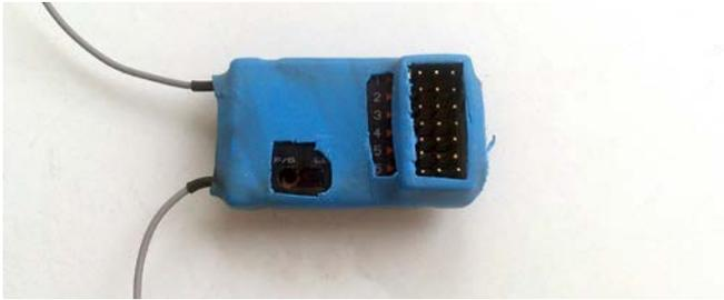
Ilustración 6: Ejemplo receptor de señal de radio.
