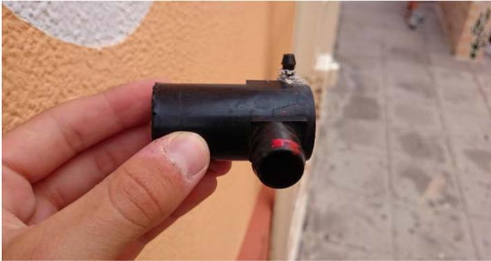
Por la boquilla grande del motorcillo obtenía agua y por la boquilla pequeña expulsaba el agua que obtenía, este motorcito lo introducimos en la parte alta del robot, así hacíamos que el agua ocupara toda la tubería y expulsara el aire que estaba en el interior de la misma, para ello practicamos unos pequeños orificios por debajo de robot submarino.
