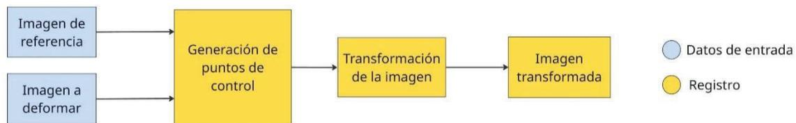
Figura 3.14 Diagrama de bloques del registro.
