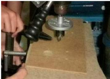
Una vez dibujadas las marcas, realizar los orificios para los pulsadores y el joystick con la ayuda de un taladro.
