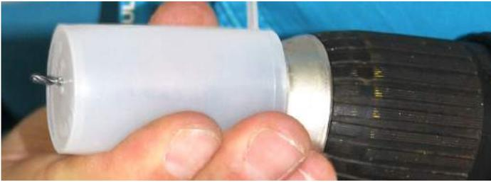
El siguiente paso es el encapsulado de los motores, utilizar para ello un bote de plástico cilíndrico cuyas dimensiones interiores sean lo más parecidas a las dimensiones del motor. Para el tipo de motor utilizado en este manual son apropiados los botes de los antiguos carretes fotográficos.
