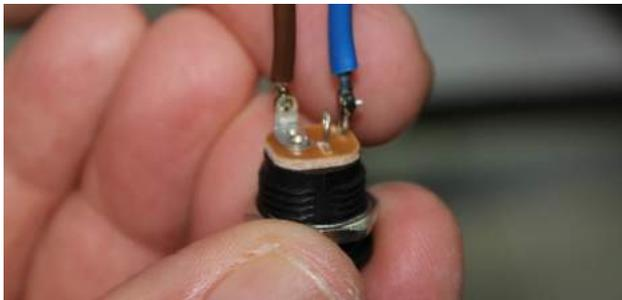
Para el funcionamiento de este modelo de robot submarino se debe disponer de una fuente de alimentación o batería, por lo que será necesario realizar también las conexiones eléctricas adecuadas para ello. En este caso se ha utilizado una fuente de 12V - 5 A y un jack hembra apto para dicha fuente.
