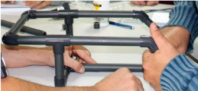
Será necesario disponer de un boceto del modelo que se desea construir. Se muestran algunos ejemplos con sus medidas, en función del modelo será necesario un número diferentes de codos, tubos y uniones "T". Es totalmente personalizable, pudiendo crear tu propio diseño y pintarlo de colores vivos para que el ROV se vea bien dentro del agua, **ánimate a crear un diseño propio!!!**
