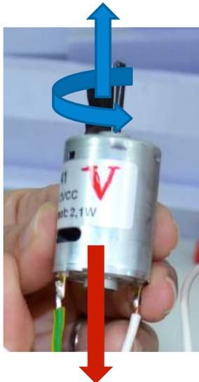
Para ver el giro de los motores que se van a instalar en el ROV se debe tener en cuenta “La regla de la mano derecha”: si el motor realiza un giro en sentido contrario a las agujas del reloj (antihorario), empujará el agua hacia arriba y desplaza el vehículo hacia abajo.
