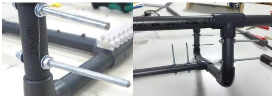
El motor vertical debe estar preferentemente situado en el centro de gravedad de la estructura y se orientará hacia arriba. Los motores de movimiento horizontal se colocarán en las barras laterales de la estructura orientados hacia atrás para facilitar la propulsión y han de estar bien alineados uno con el otro.
