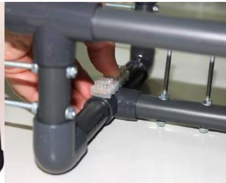
Conectar los cables de los tres motores a la regleta del chasis respetando la distribución de colores en la misma posición que la regleta de 6 puertos instalada en la consola, la cual conectará con el joystick y los pulsadores. Sujetar los cables al chasis con bridas para que no queden sueltos.
