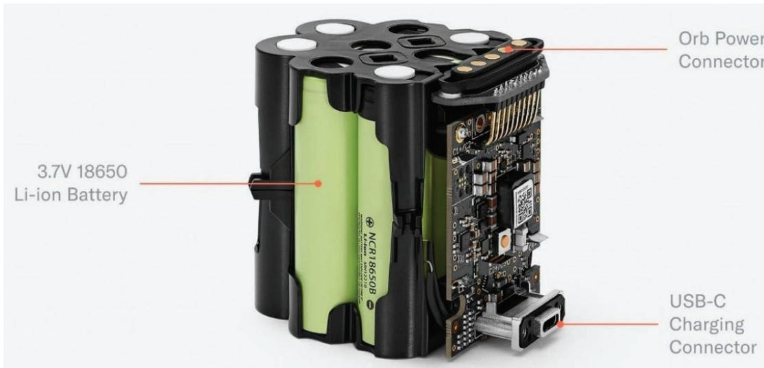
Figura A.4 Sistema de energía
