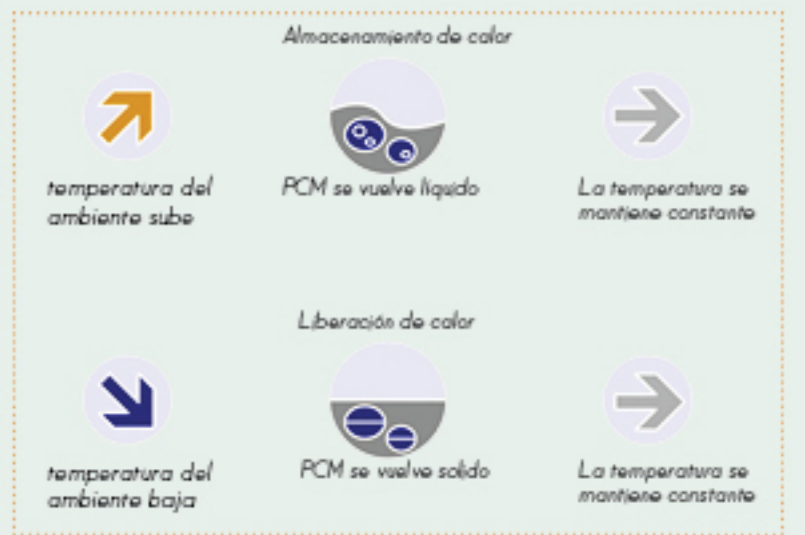
Esquema de funcionamiento de material de cambio de fase
