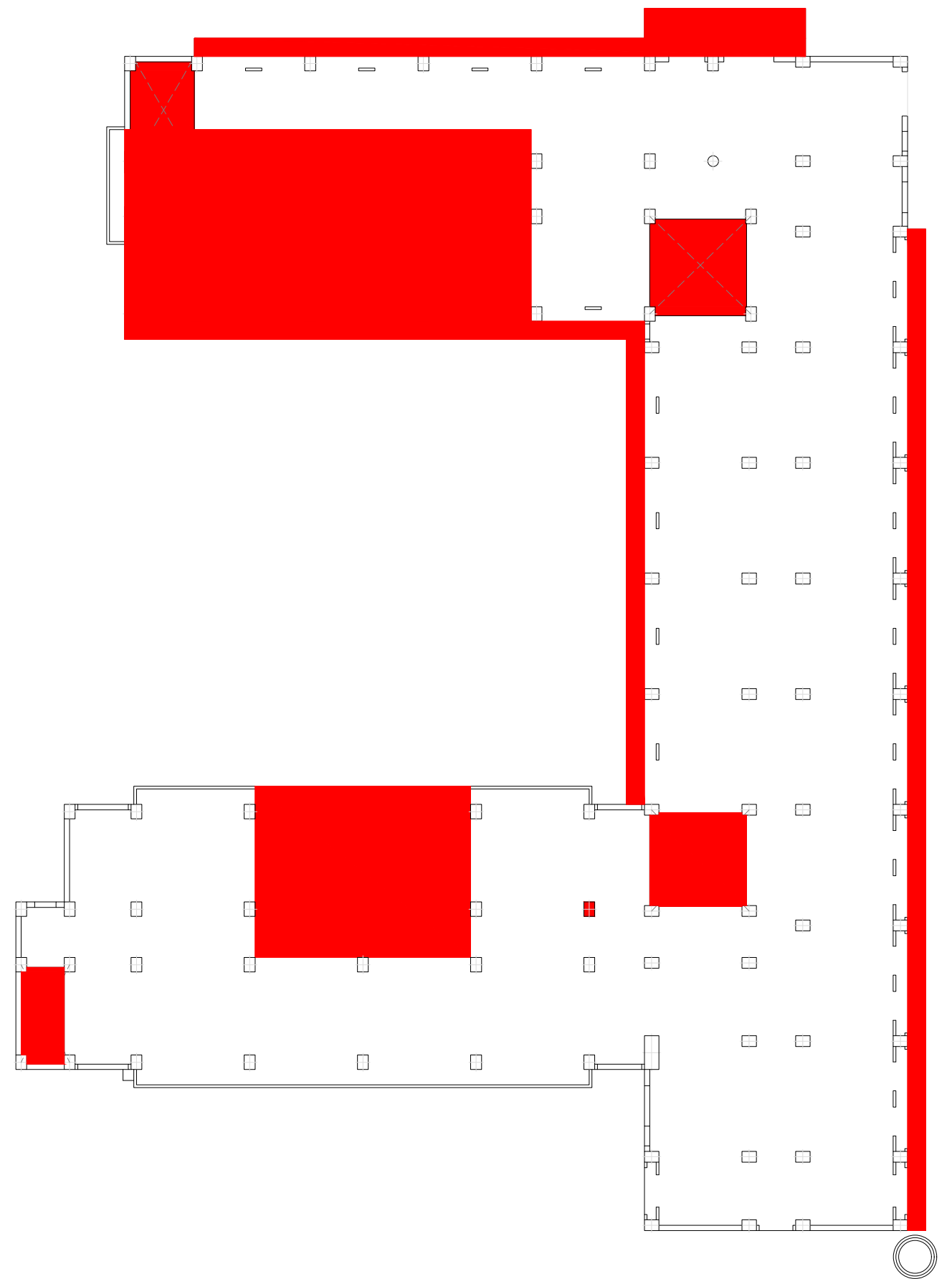
PLANTA 5. DEMOLICIÓN DE FORJADOS E 1:300
