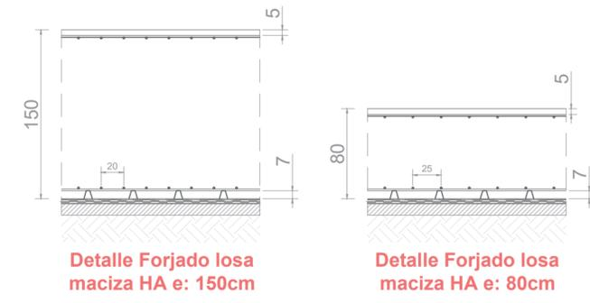
La tipología estructural de la cimentación es la losa de hormigón armado apoyada sobre el terreno con un sistema de contención de muro flexoresistente de H.A. Los soportes mayoritarios son pilares, aunque debido a la transmisión y apoyo de los esfuerzos producidos en los volados superiores, existen una serie de muros estructurales.
