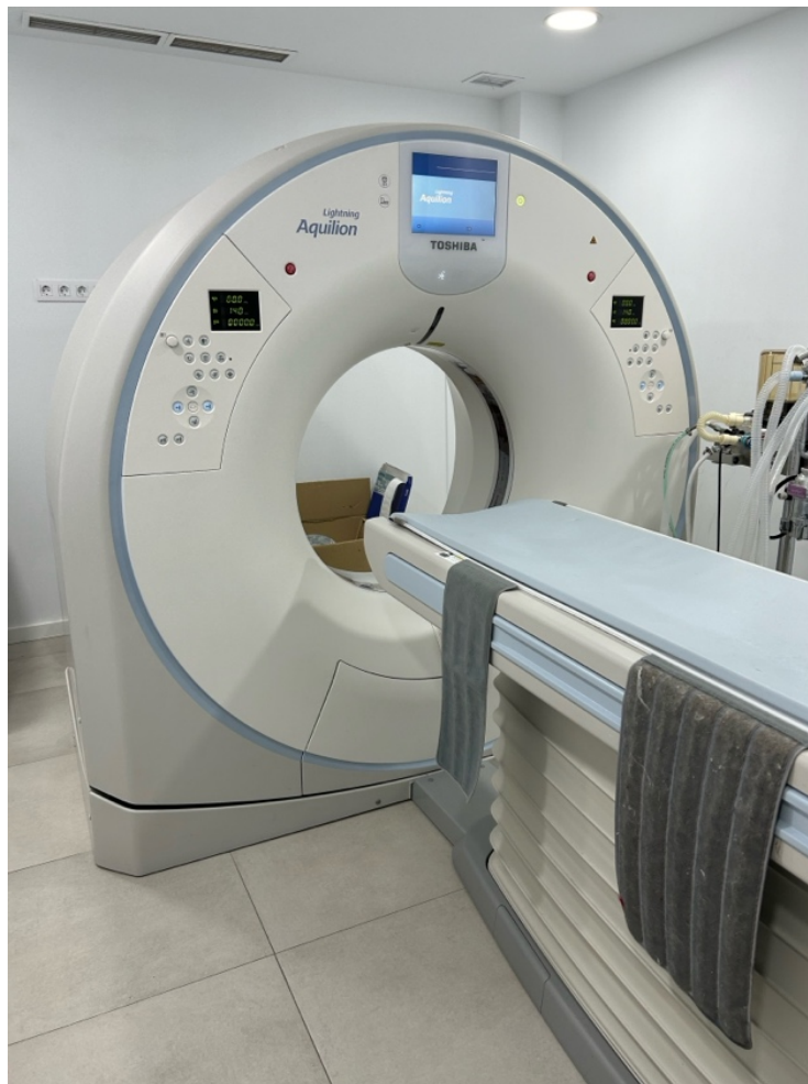
Figura 16. Gantry, la mesa o camilla para posicionar al paciente, componentes de Tomografía axial computarizada. Fuente: Hospital Veterinario Los Tarahales.
