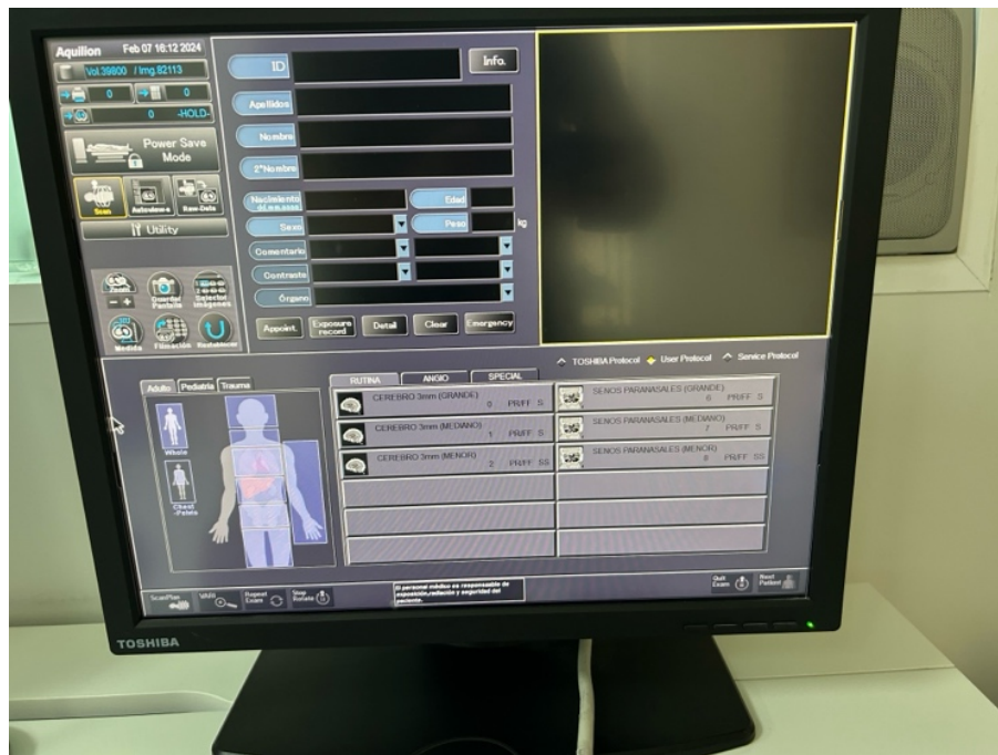
Figura 18. Consola del Operador de Tomografía axial computarizada. Fuente: Hospital Veterinario Los Tarahales.
