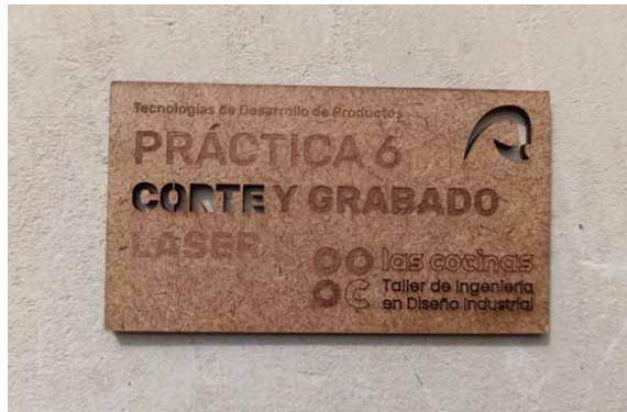
Figura 1. Imagen de pieza resultado de una práctica de corte y grabado láser.
