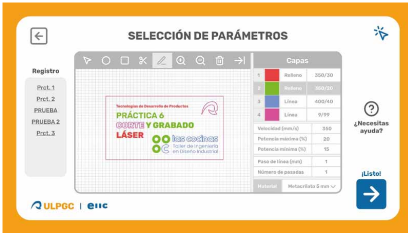
Figura 3. Pantalla de selección de parámetros de la UI del laboratorio remoto.
