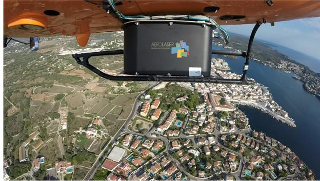
Ilustración 2.3: LiDAR en helicóptero tomando escenas de poblado. Cortesía de AeroLaser System S.L.
