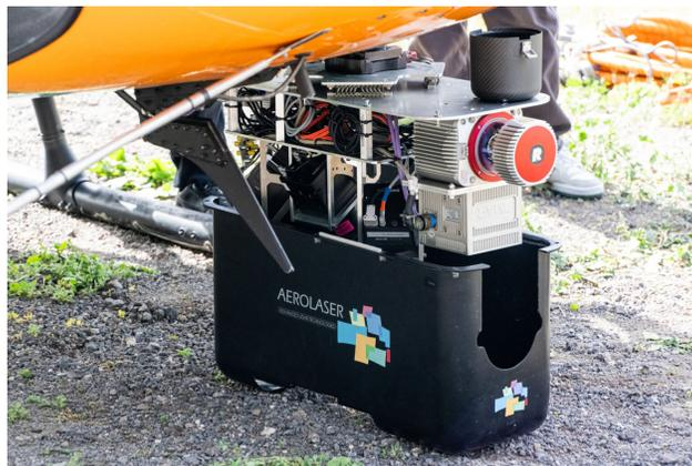
Ilustración 3.9: Sensor LiDAR propiedad de AeroLaser System S.L.
