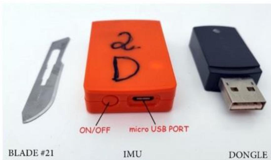
Figura 19. La apariencia externa de una IMU y la llave de conexión inalámbrica. Fuente: (Figueirinhas y cols., 2022)
